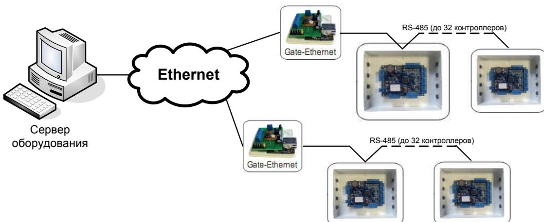
Для каждого преобразователя должен быть задан свой статический IP-адрес и выполнены настройки параметров сети. Настройка преобразователя выполняется по локальной сети. Для этого используется специальная утилита конфигурации – «Gate-Ethernet Configuration Tool». Она устанавливается на компьютер автоматически при установке драйвера Irium-Gate (версии 1.0.4. и выше).
